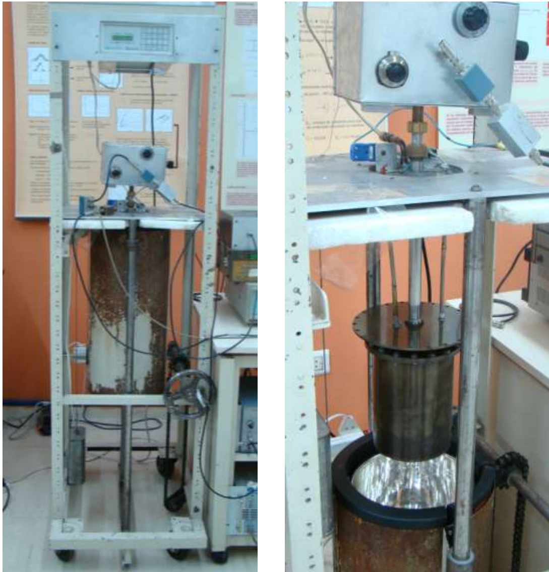
Figura 20: Vista general del criostato.
