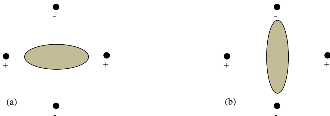
Figura 1: Esquema representativo del momento cuadrupolar nuclear en presencia de una distribución de carga.
