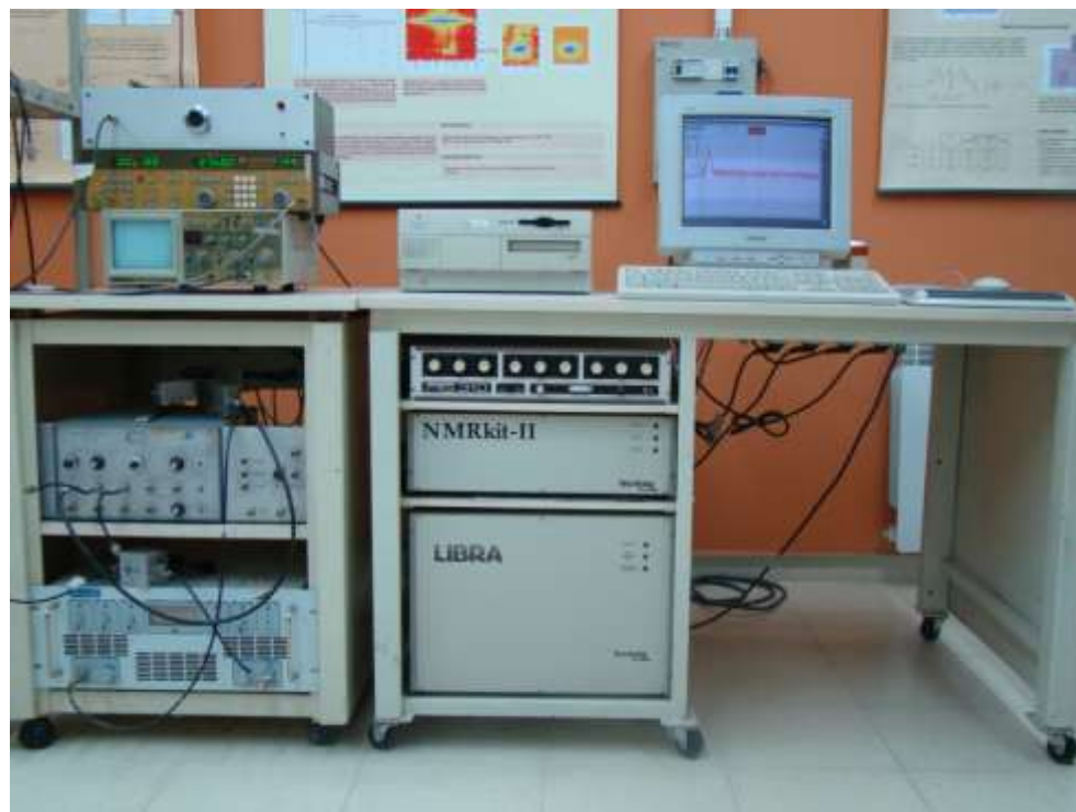
Figura 19: Sistema transmisión/ recepción de un espectrómetro de NQR.
